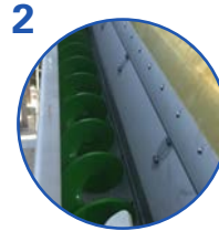
2 Vis compacteuse Obtention d'un déchet compact et réduction des volumes supérieure à 50%.
