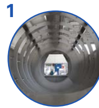
1 Tambour filtrant Perforation de 0,8 à 10 mm.
