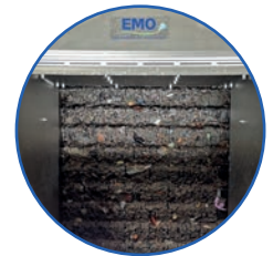
2 Tapis de déchets constitué contre les lames (filtre supplémentaire)
