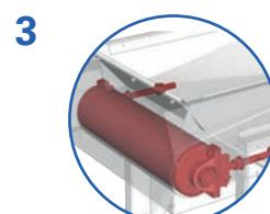
Tension tapis ajustée au moyen d'une tige filetée mécanique
