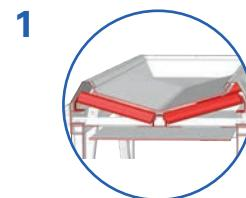
Station en « V » ou en augle pour un guidage optimal de la bande
