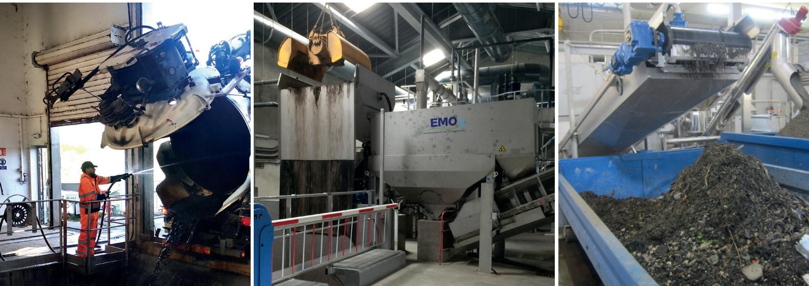
Les matières fines (MO+Sable) sont reprises par une pompe avec l'eau de lavage du Trommel et sont transférées vers le **laveur à sable**.
