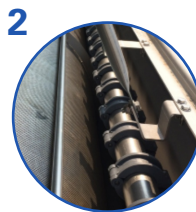
Rampe de lavage équipée de buses pour assurer le lavage extérieur du tambour.
