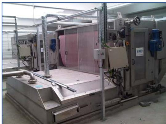
**Filtro banda OMEGA 1300 con capotaje**
