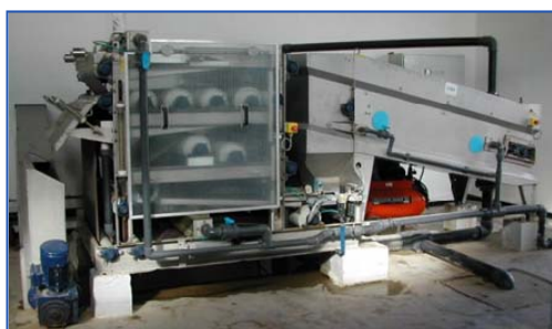
Mesa espesadora combinada en línea con un filtro banda
